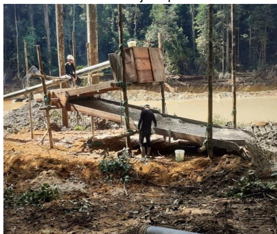
Homogeneização e quarteamento da amostra da alimentação e do rejeito
