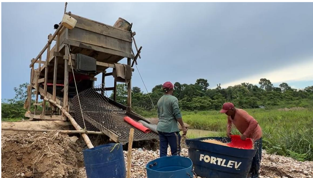
Figura 67. Concentração do material da calha concentradora
