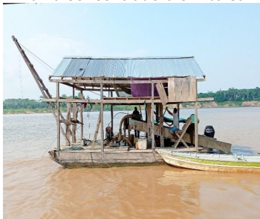
Calha concentradora em balsa
