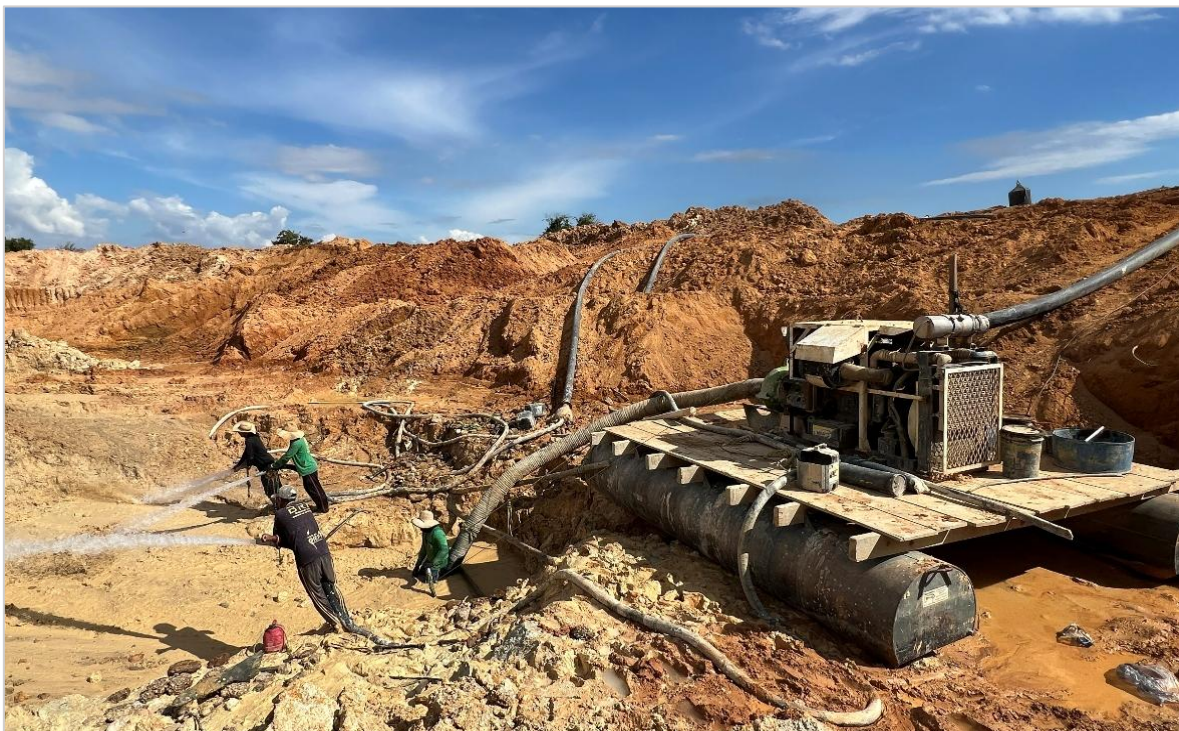
Figura 53. Monitor hidráulico usado em operações de baixão
