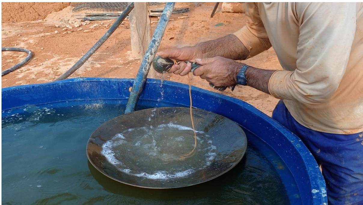
Figura 65. Remoção do excesso de mercúrio na filtração antes da queima
