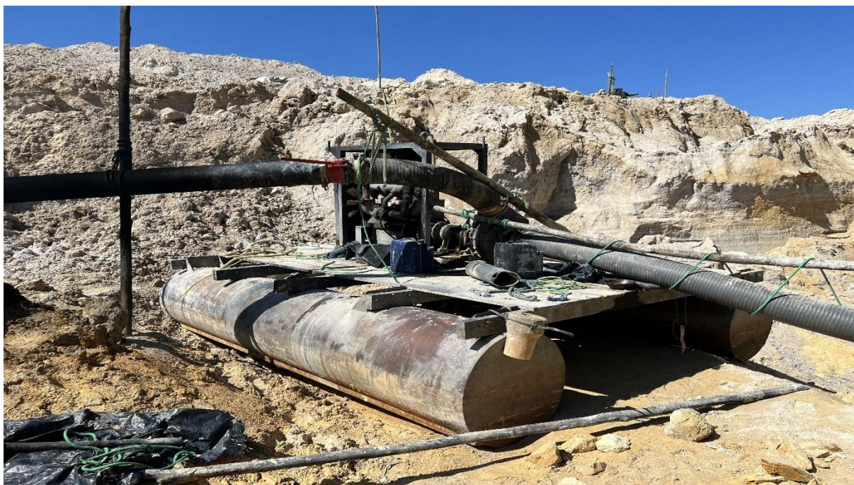
Figura 54. Monitor hidráulico usado em operações de baixão
